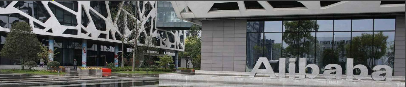
Fachada com pele de vidro cobertos com fachada metálica vazada externa fixada a estrutura.
